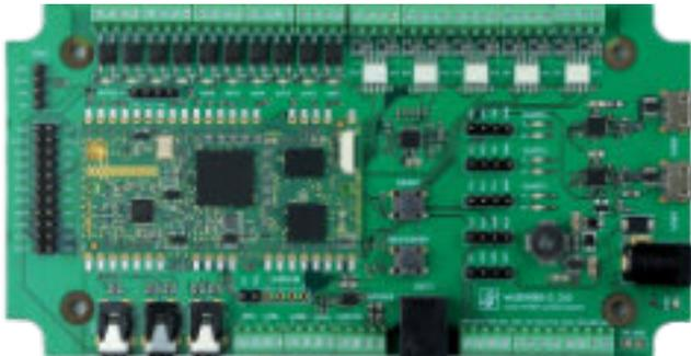
Bild 1: Sprachsteuerungshardware vicBASE-3\_5.0
