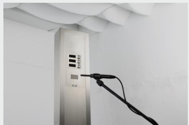
Bild 3: Akustikmessung einer Wechselsprechanlage im Labor
